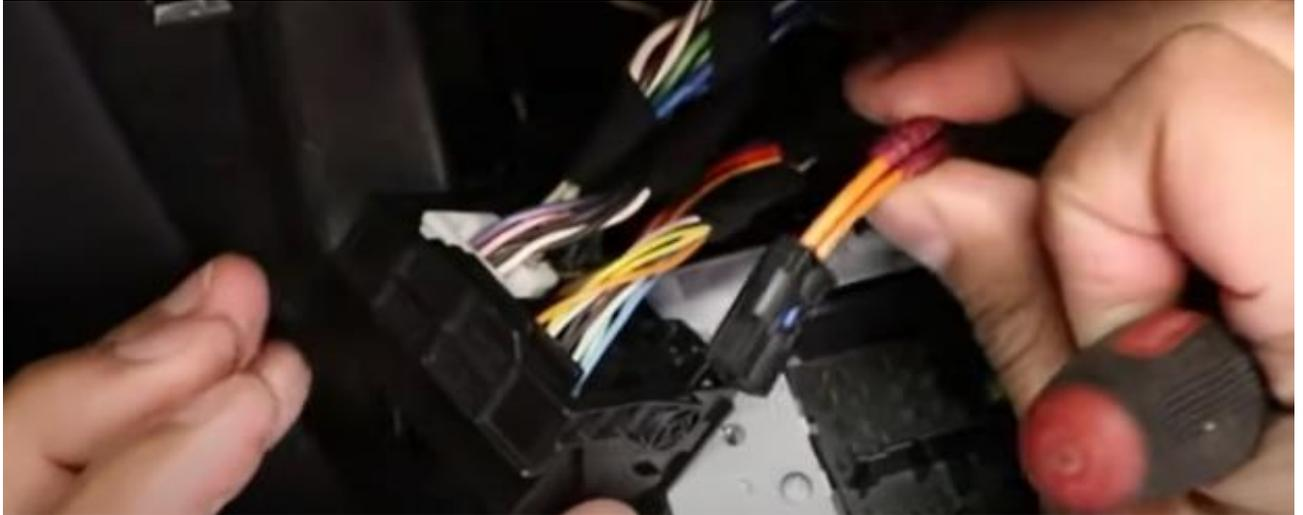
Übertragen Sie diesen Stecker in Übereinstimmung mit der alten Position in die neue schwarze Steckdosenleiste, die am Radio angebracht wird.
