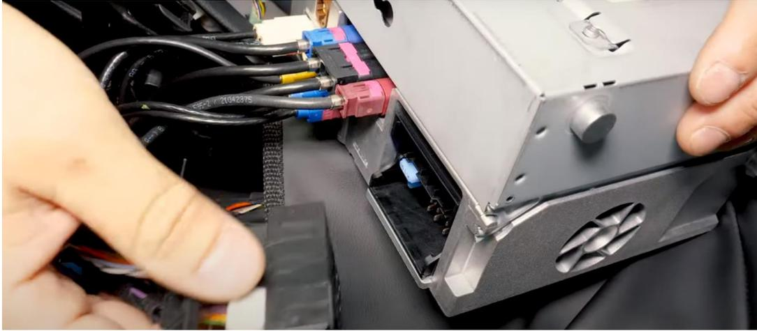
Übertragen Sie (falls vorhanden) die beiden optischen Kabel (normalerweise orange gefärbt).
